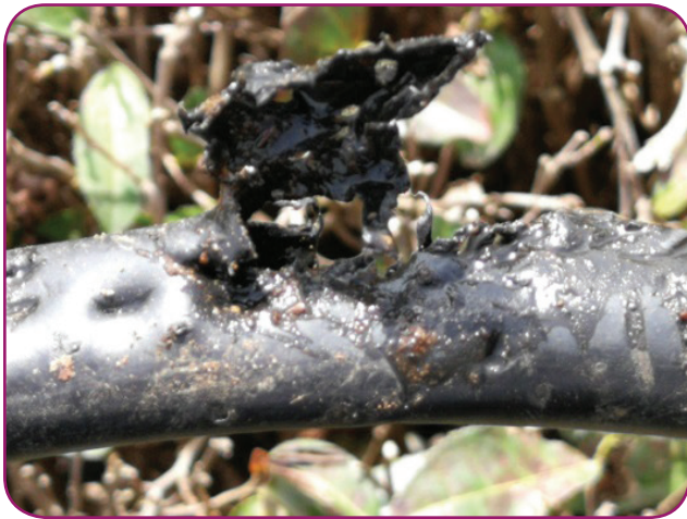
شکل ۷- جویده شدن لوله‌های آبیاری قطره‌ای توسط جوندگان
